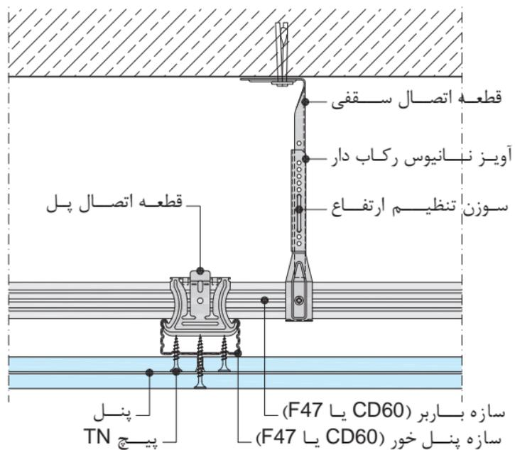
**D-112-AJ05** اتصال و درزگیری لبه برش خورده در ساختار دو لایه سقف تیپ A
